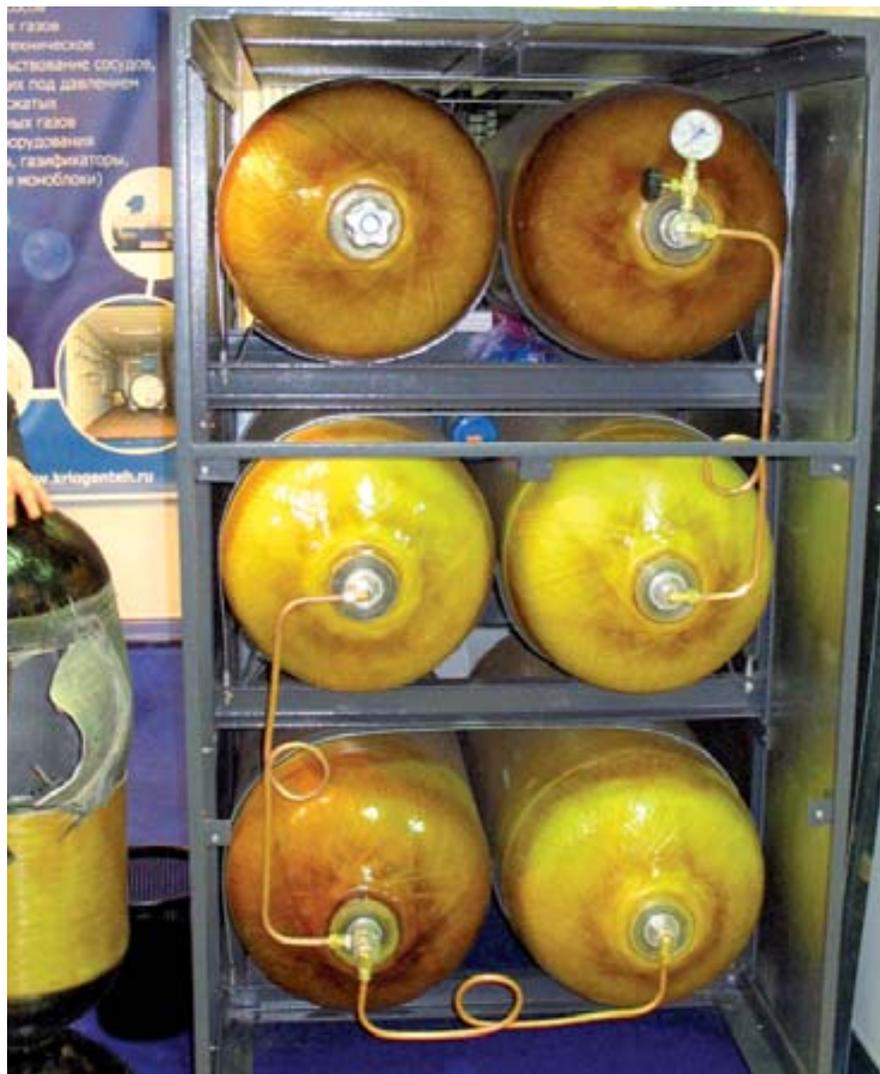
Блок металлокомпозитных баллонов ООО «Технические газы», заменяющий 20 стальных 40-литровых баллонов
