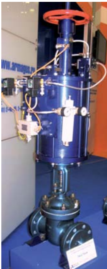
Клиновая фланцевая задвижка с выдвижным шпинделем 30с676нж
