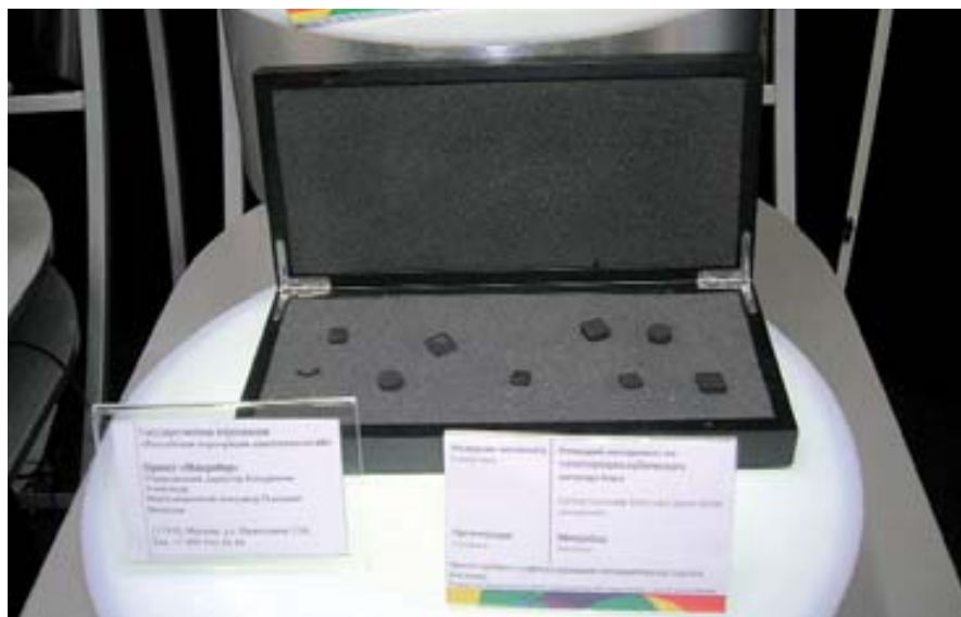
Режущий инструмент из нанопорошка кубического нитрида бора
