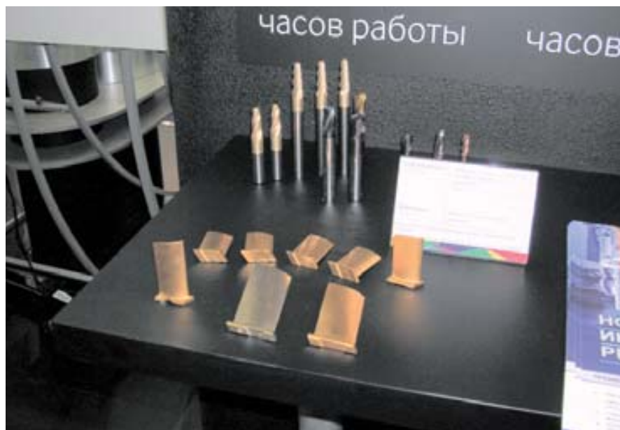
Металлорежущий инструмент с наноструктурированным покрытием
