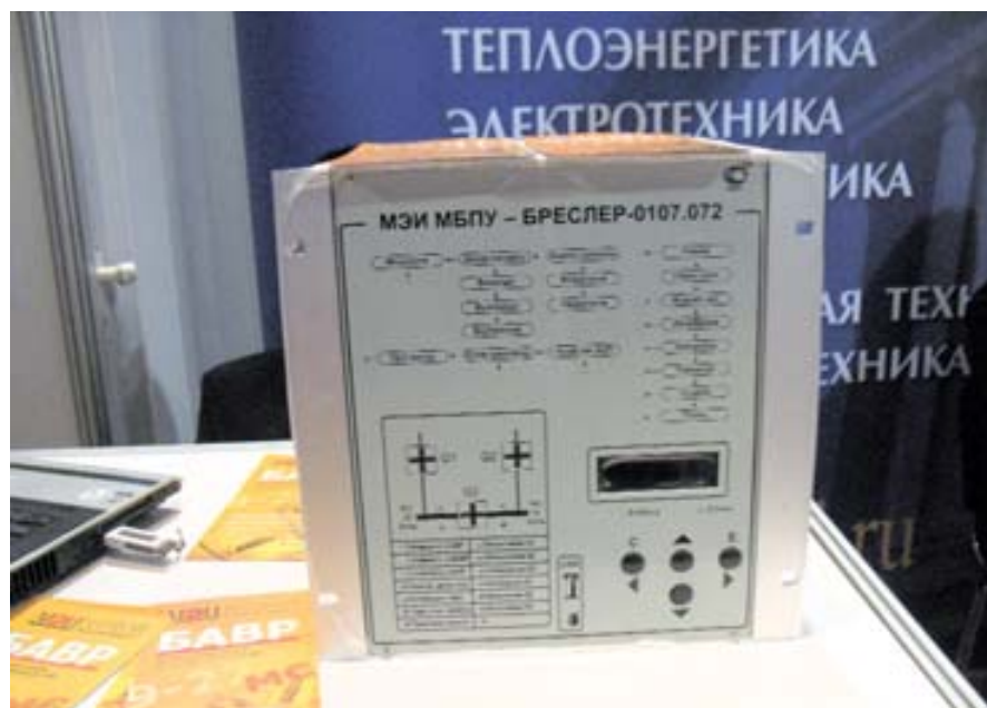
Устройство быстродействующего автоматического включения резерва, разработанное в МЭИ
