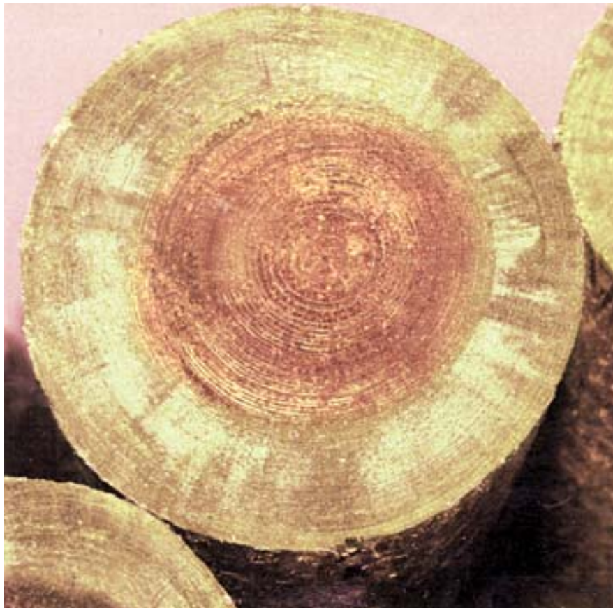
Образец антисептированного бревна, предназначенного для изготовления опор ЛЭП (продукция Сеесъярвского мачтопропиточного завода)
