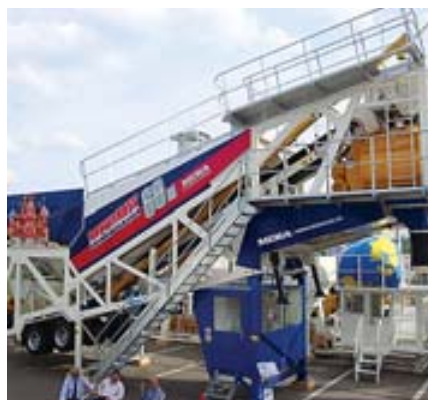
Смесительный блок мобильной БСУ МЕКАМИХ-100-М
