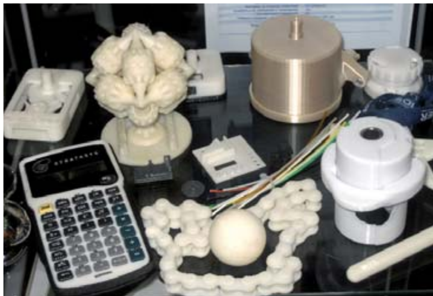
Образцы изделий и деталей из пластика ABSplus, полученные с применением 3D принтеров Dimension FDM 200 mc
