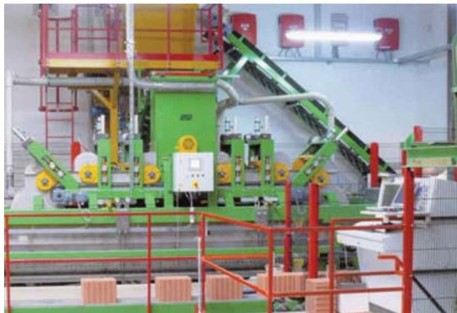
Линия для заполнения многопустотного кирпича минеральным волокном
