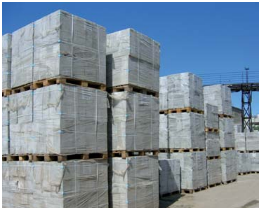
Пенобетон на стройплощадке
