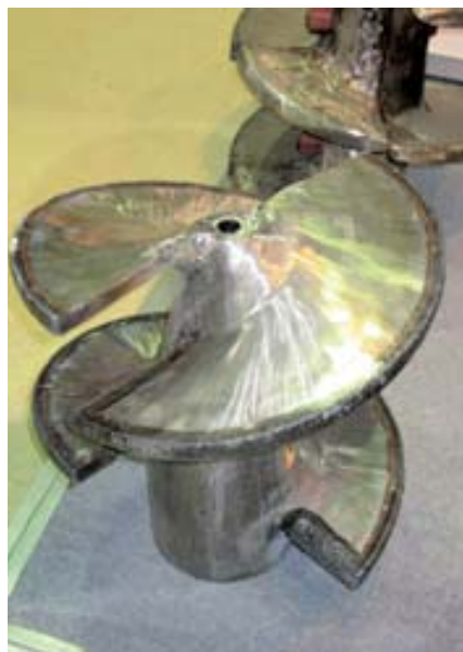
Фрагмент шнека с бронирующим покрытием
