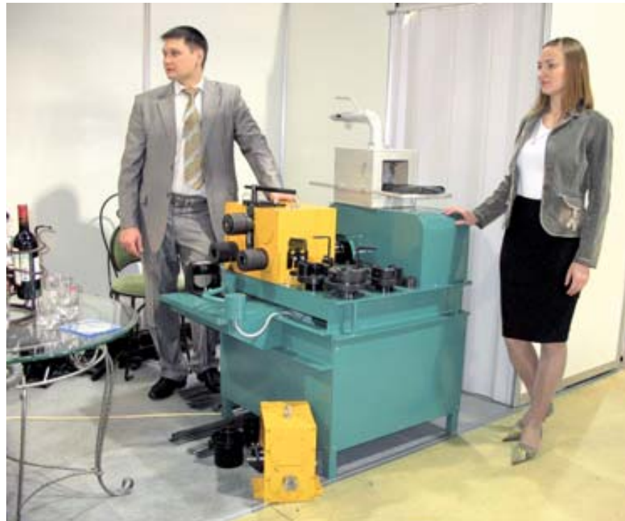
Универсальный привод «Декор» с универсальным кузнечно-гибочным блоком
