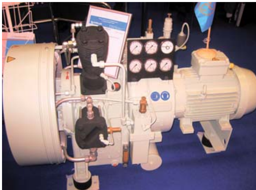
Поршневый компрессор с воздушным охлаждением серии H VP 4331 на стенде ООО «Далва Консалтинг»
