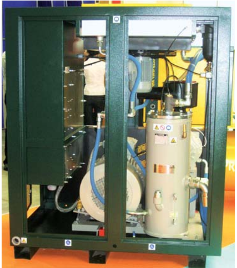
Воздушный винтовой компрессор ЕКОМАК с прямым приводом
