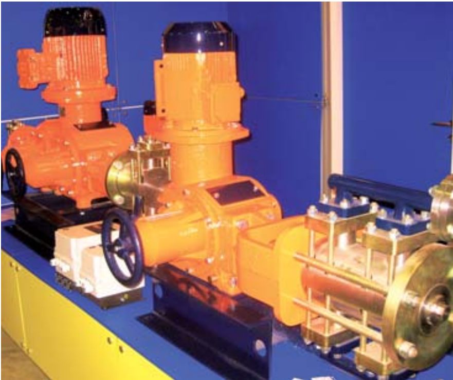
Дозировочный электронасосный агрегат Талнахского завода
