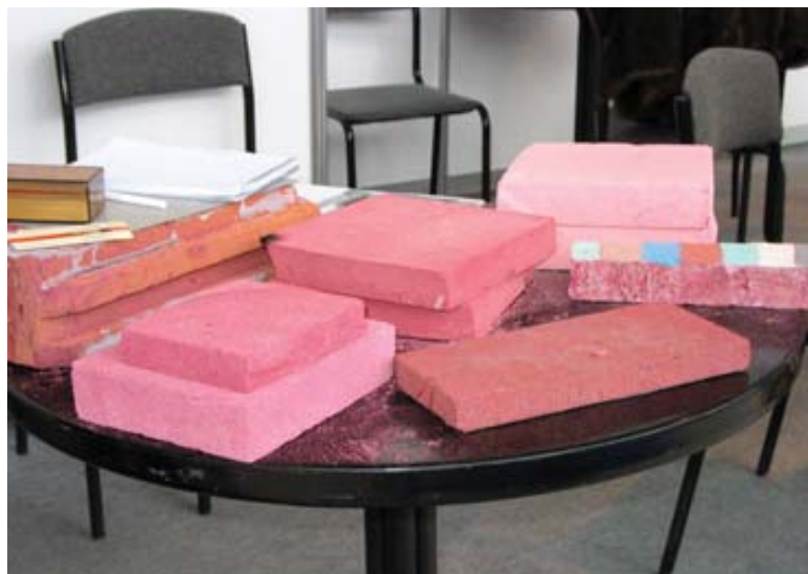
Образцы резольно-новолачного пенопласта «Теплор», разработанного компанией «УниверХимТех»
