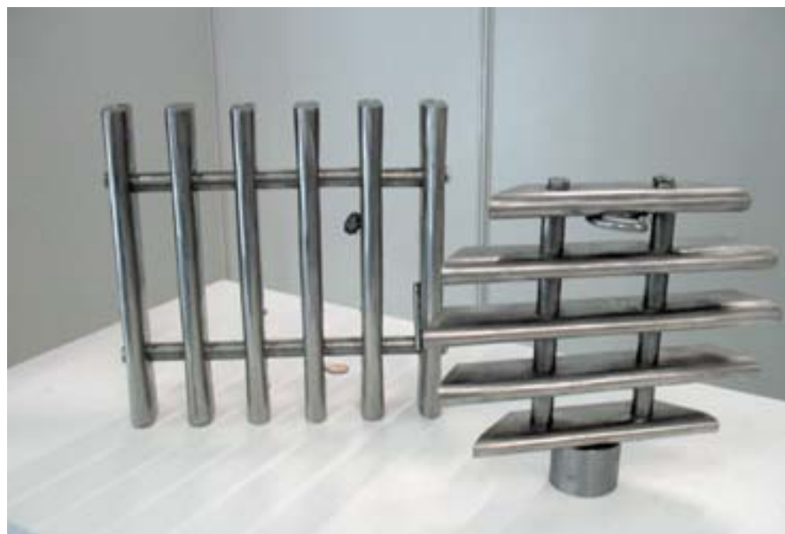
Магнитные сепараторы решетчатого типа, разработанные МГТУ «МАМИ»
