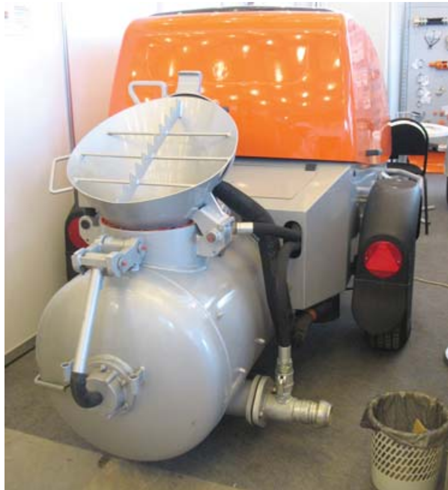
Пневмонагнетатель Estrich Boy 450 с трехцилиндровым дизельным двигателем
