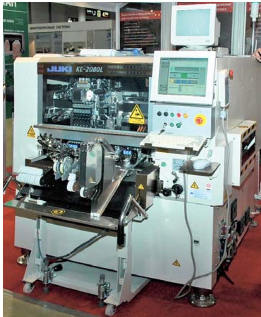
Высокоскоростной автомат установки компонентов JUKI KE-2080 на стенде компании «Совтест АТЕ»
