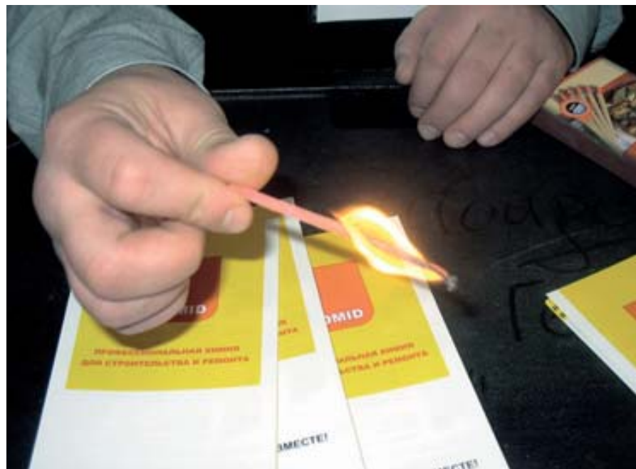
Пример использования защитного средства марки NEOMID — обработанная им часть спички не горит
