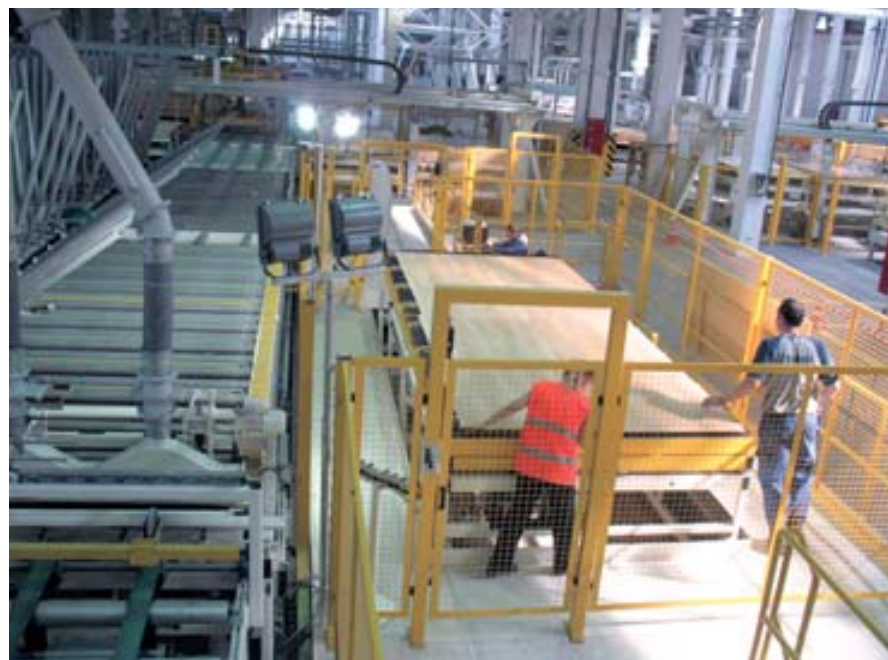
Проверка геометрических размеров ламинатной доски
