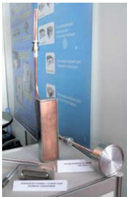
Магнетронная распылительная система с дисковым катодом
