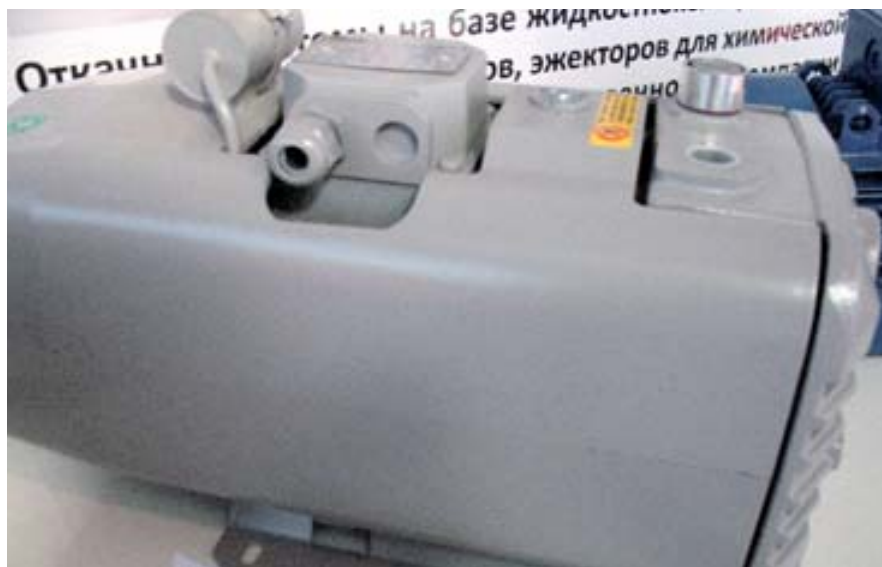
Пластинчато-роторный насос DVP, предлагаемый компанией MSH Techno
