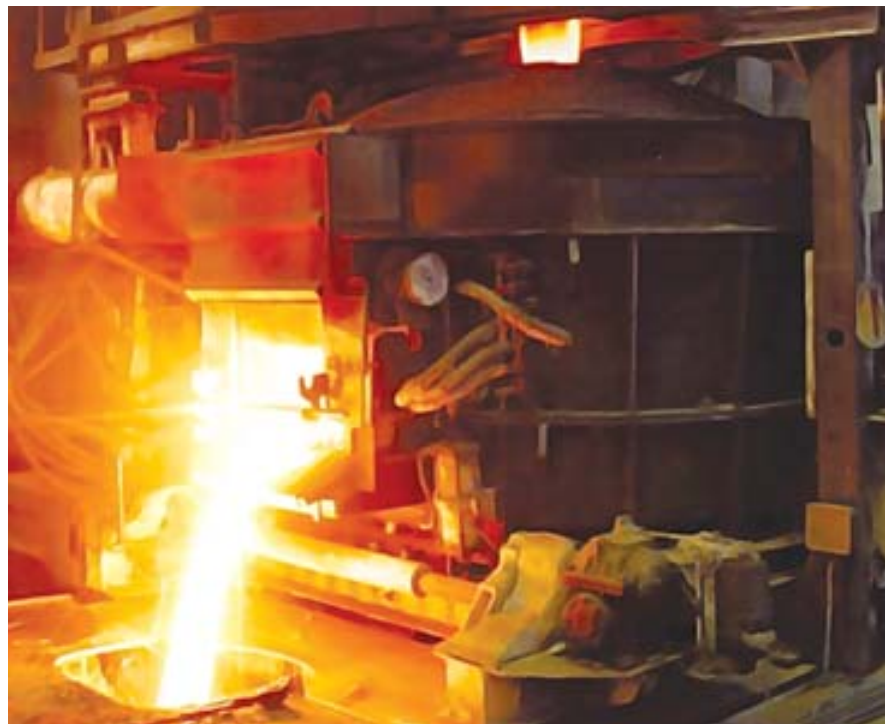
Дуговая печь ДППТУ-6, установленная на Металлургическом заводе «Электросталь»
